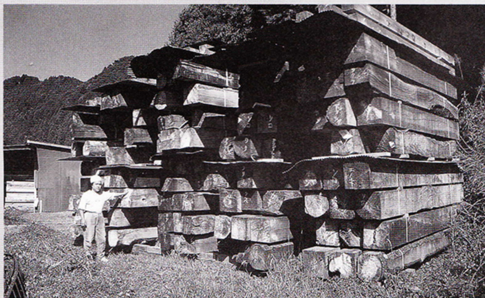
▲一般には使われない広葉樹から製材された尺角材を天然乾燥している (写真提供=岡部材木店)
